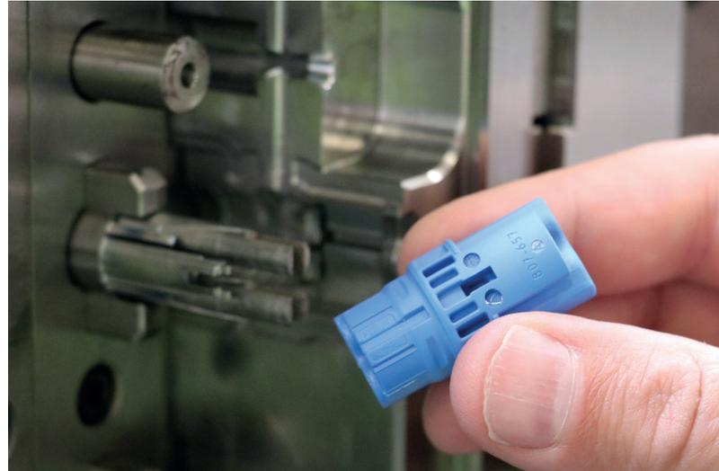
**Die Steckverbinder** entstehen aus komplexen Spritzguss-Werkzeugen mit bis zu 128 Kavitäten © Haimer
