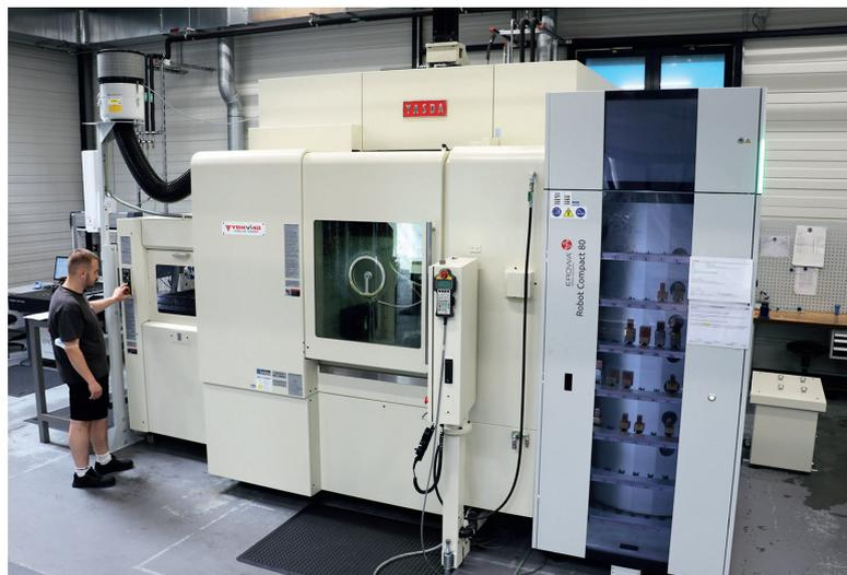
**Bei Alhorn ist die Hochpräzision zuhause:** Auf dem Yasda-BAZ 'PX30' (Bild) bearbeitet der Lübbeker Werkzeugbauer diffizile Formeinsätze, auf einer YMB Vi40 vom selben Hersteller werden Kupferelektroden gefräst; Haimer-Werkzeugaufnahmen, -Schrumpfspanntechnik und -Voreinstellung tragen dazu bei
